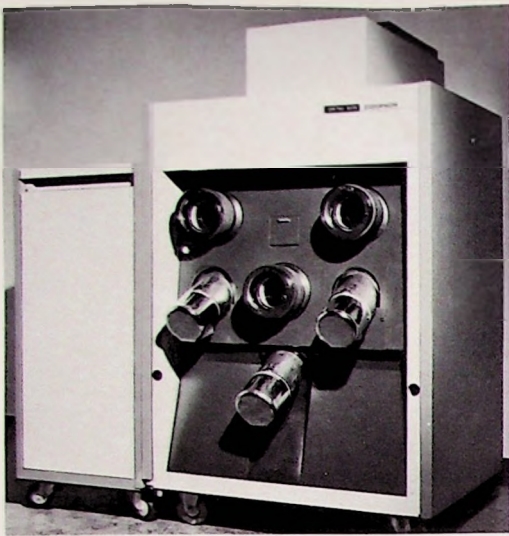
Bild 4. Vorderansicht des Eidophor - Projektors Gretag „5070“
